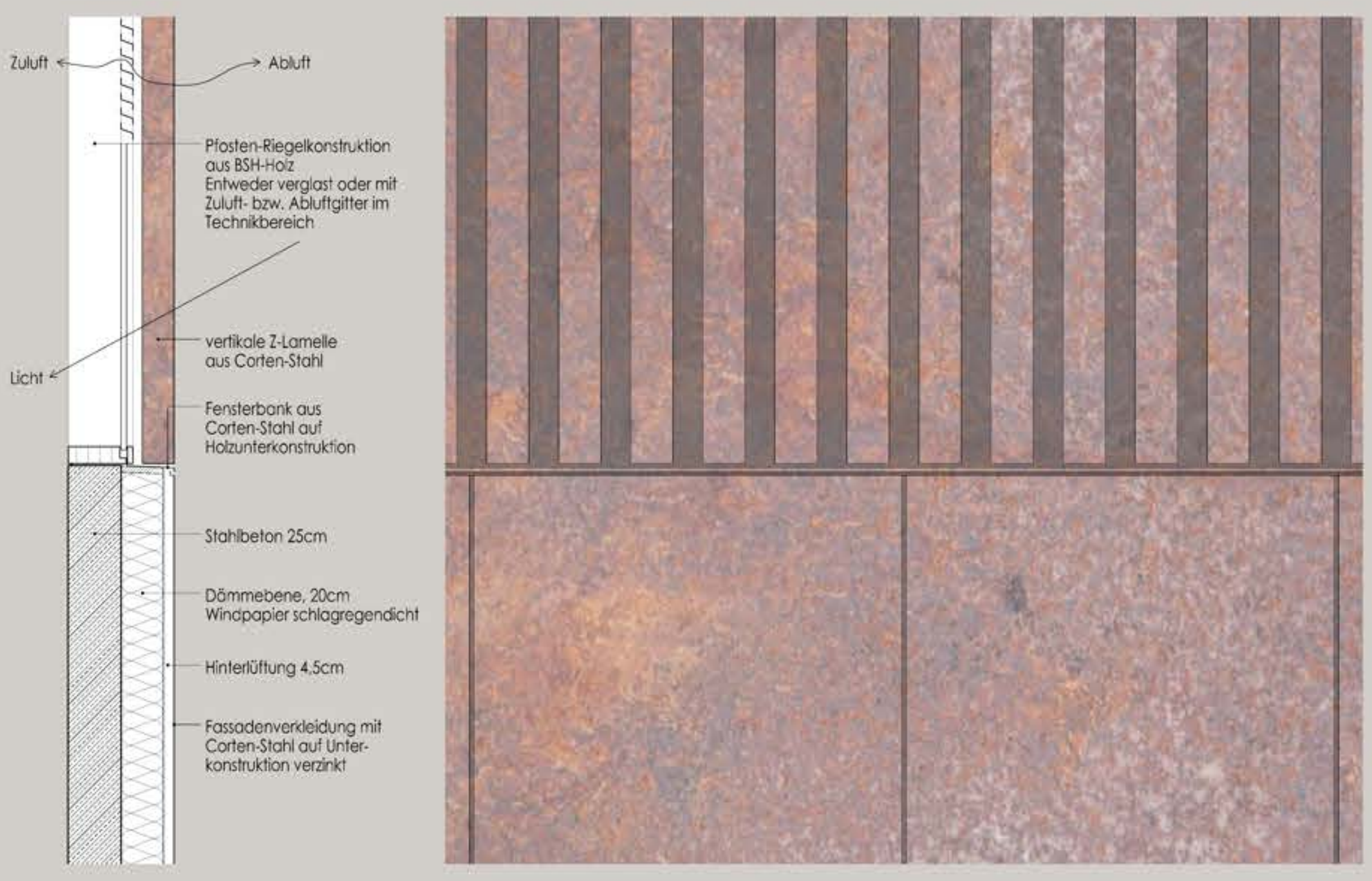
Fassadenschnitt und Ansicht M 1:20
